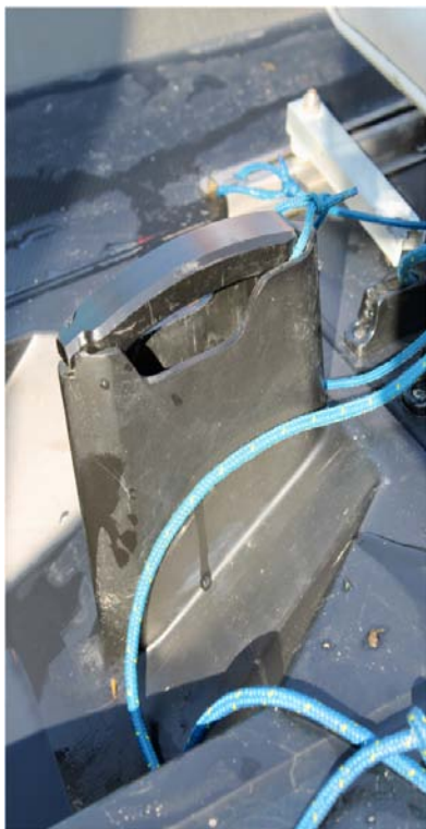
Figuur 5.7 Vin volledig omlaag
