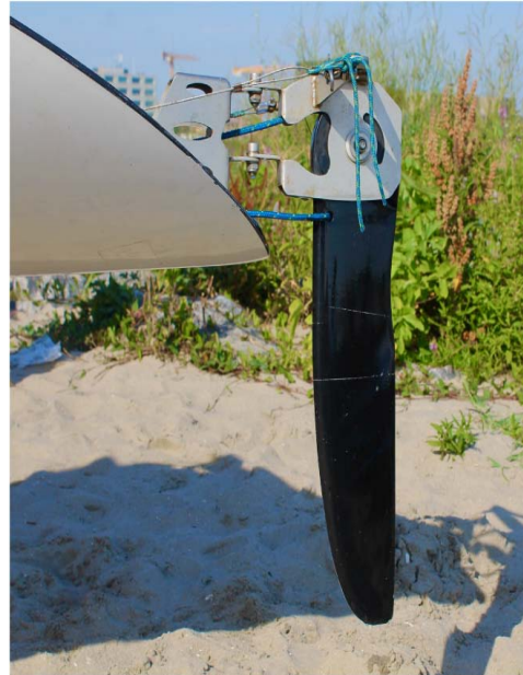
Figuur 5.3 Roer in verticale positie
