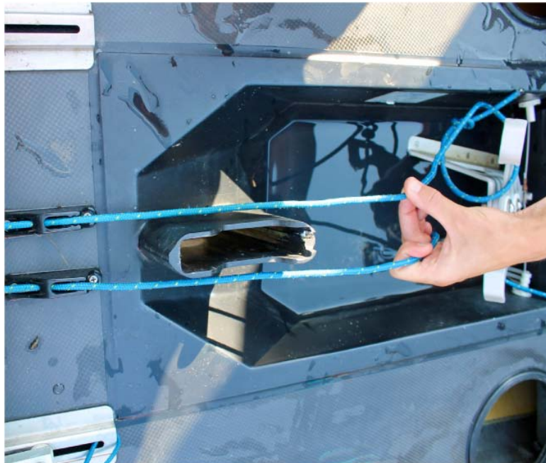
Figuur 5.4 Twee lijnen voor de bepaling van de stand van het roer
